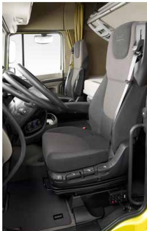
*Регулируемое рулевое колесо конструкции (по специальному заказу может быть с кожаной отделкой) с функциями регулировки высоты (85 мм.) и угла наклона (от 30° до 45°).*
